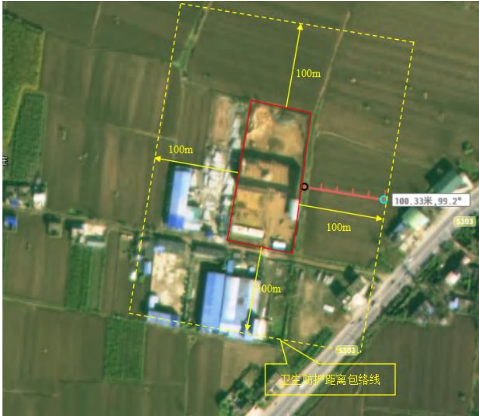
图 5.2-30 项目卫生防护距离图 注：黄色虚线为本次卫生防护距离范围
